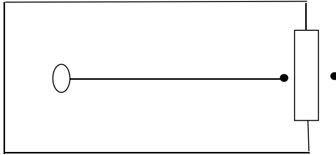
图 6.3-1 室内声源等效为室外声源图例
