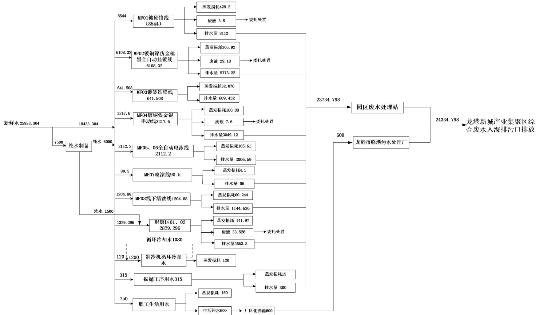
图 4.4-1 建设项目水平衡图 (单位: t/a)
